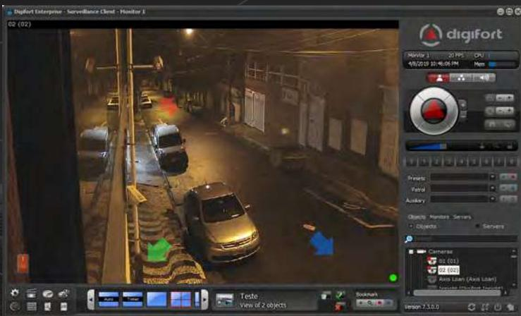
▲ Navegación de enlaces de objetos (navigue a través de objetos utilizando enlaces de superposición en cámaras en vivo y de reproducción)
