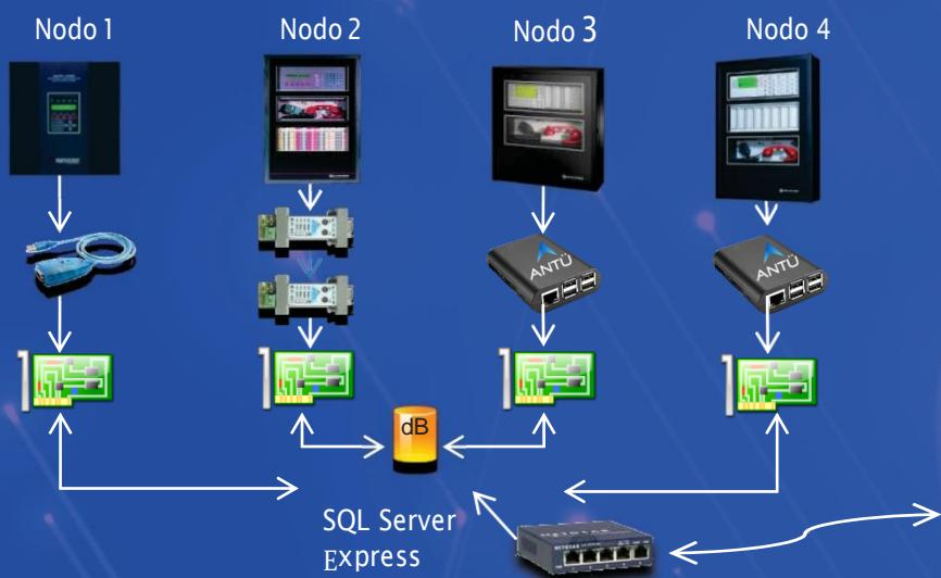
Conversión de los mensajes reportados por la central de incendio de RS-232 a TCP/IP a través de una red Ethernet para el monitoreo Remoto.
