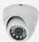
DPPX36 Domo antivandálico 700 TVL Filtro IR mecánico
